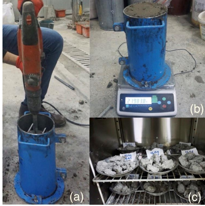
Şekil 2. (a) SSB numunelerinin sıkıştırma işlemi, (b) Sıkıştırılmış betonun ağırlığının belirlenmesi, (c) Etüvde 24 saat bekletilmiş beton
